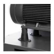
**Низкий уровень шума** также достигается применением шумопоглощающих панелей, установкой электродвигателя и винтового блока на виброопорах.
