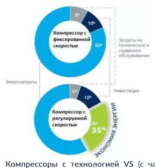
**Компрессоры с технологией VS** (с частотным регулированием вращения двигателя) позволяют гибко подстраивать производительность компрессора исходя из текущей потребности в сжатом воздухе.
