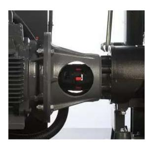
**Прямой привод** без редуктора обеспечивает высокий КПД и минимальные требования к обслуживанию. Винтовой блок имеет низкие обороты, что увеличивает его ресурс.
