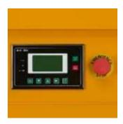
**Простота эксплуатации.** Контроллер МАМ обеспечивает автоматическое обнаружение и предупреждение о неисправностях, напоминание о техобслуживании, автоматическую защиту от перегрева и неправильного подключения, возможно дистанционное управление и мониторинг.
