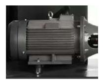
Надежный электродвигатель известного качеством производителя Jiangtian с классом энергоэффективности IE3 и классами защиты IP23, или IP55 (в зависимости от комплектации компресссора) предназначен для круглосуточного использования на предприятиях с разной степенью запыленности, имеет низкий уровень шума и вибрации.
